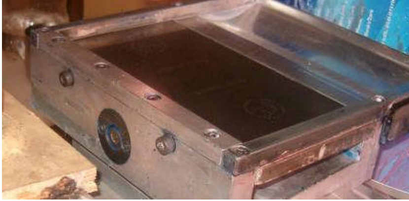
Resim 2.11: Kalıp Takma Bölümü
